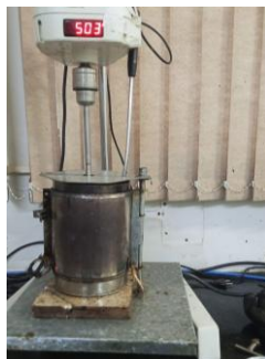
Figura 3 - Agitador mecânico com rotação de 500 rpm.
